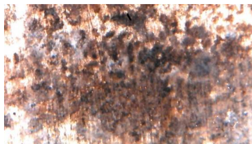
Gambar 7. Korosi Seragam Pada Plat Baja ST 40
