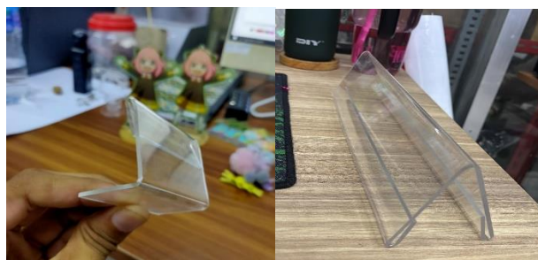
Gambar 3. Hasil tekukan 2mm dan 3mm Kreasi Group
