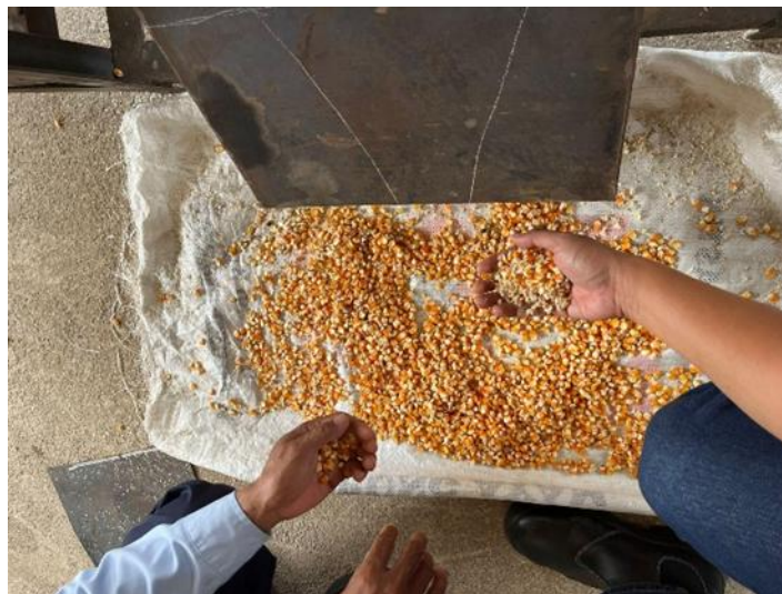
Gambar 9. Biji Jagung hasil pipilan keluar dari Hopper Output (Sumber: Dokumentasi peneliti, 2025)
