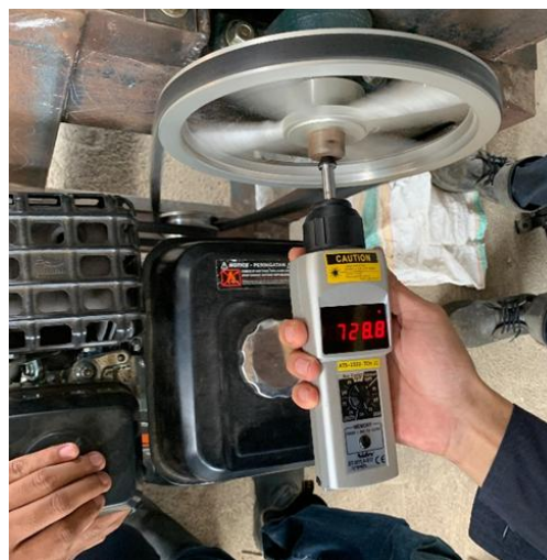
Gambar 5. Pengukuran Putaran pada Poros Pemipil (Sumber: Dokumentasi peneliti, 2025)
