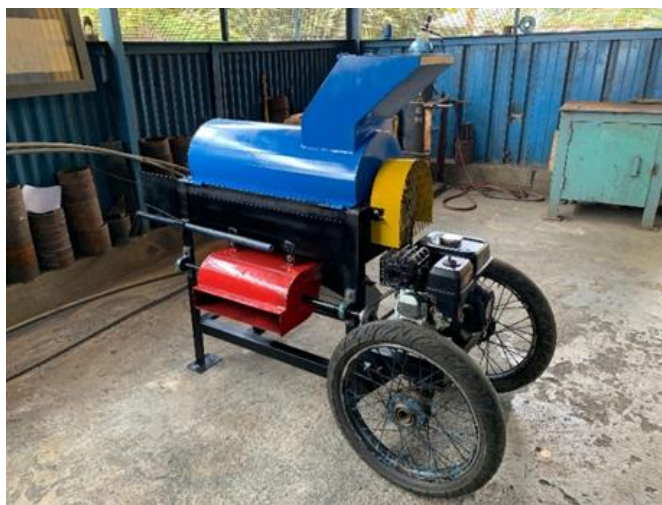
Gambar 2. Mesin Pemipil Jagung dengan konstruksi silinder bergigi (Sumber: Dokumentasi peneliti, 2025)
